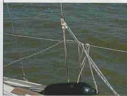
Jambor je narejen tako, da ga je mogoče v nekaj minutah podreti, delo olajša okovje na boku, postavljeno v center osi gibanja jambora pri podiranju.
